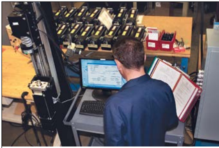
Die Funktionsprüfung über mehrere Hundert Zyklen misst Schubkraft, Länge, Leerlaufdrehmoment, Eingangsstrom zu Standardabweichung der Kraft.
