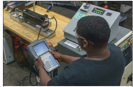
Die abschließende Systemprüfung stellt sicher, dass die Feedback-Einrichtung genau an die Pole des ServoWeld-Motors angepasst ist.
